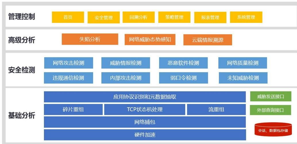
系统采用零拷贝技术，实现高速流量接入。实时进行会话重建、协议识别、网络威胁检测等功能。
